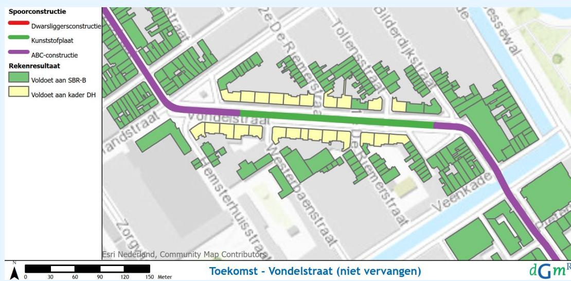
figuur 11: rekenresultaten Vondelstraat na wijziging (spoorconstructie blijft gehandhaafd)
