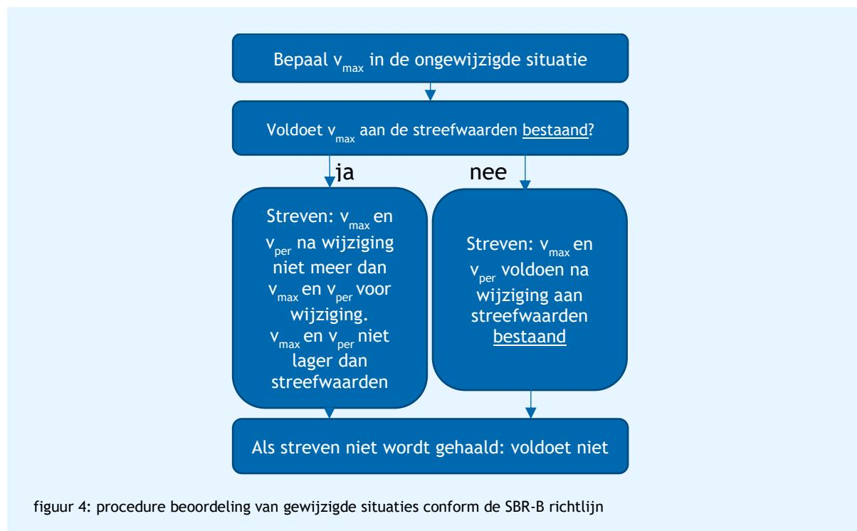
figuur 4: procedure beoordeling van gewijzigde situaties conform de SBR-B richtlijn
